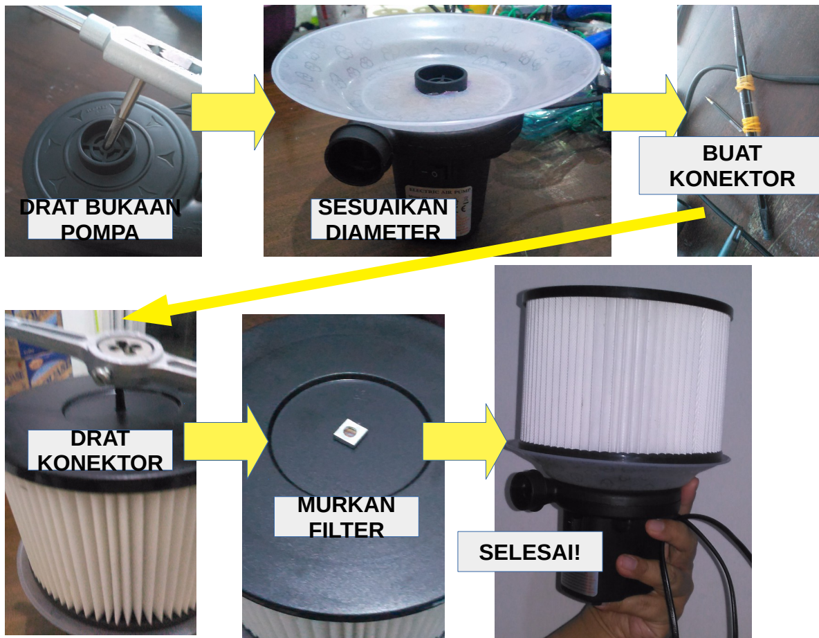
Gambar 2: Merangkai Pompa Ventilator
